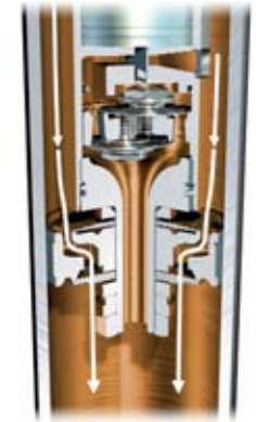
Zugstufe – nur Arbeitskolben, rennsportlich straffe Abstimmung
