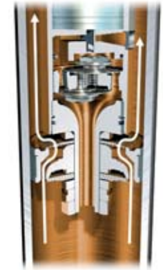
Druckstufe – nur Arbeitskolben, rennsportlich straffe Abstimmung
