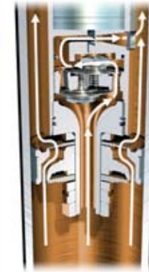
Druckstufe – Arbeitskolben und Bypass, sportlich straffe Abstimmung
