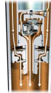
Zugstufe – Arbeitskolben und Bypass, sportlich straffe Abstimmung
