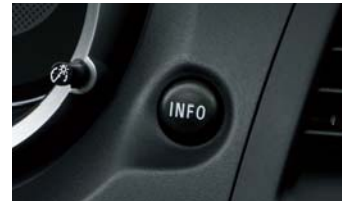
マルチインフォメーションディスプレイ切替スイッチ
