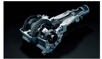
ACDトランスファー(カットモデル)
