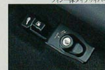
フューエルリッドオープナー(キーロック付) & エンジンフードオープナー(キーロック付)
