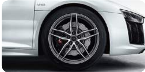
アルミホイール 5ツインスポークデザイン マットチタンルック ポリッシュ (フロント：8.5Jx19 / リヤ：11Jx19) (鍛造) +フロント：245/35 R19タイヤ / リヤ：295/35 R19タイヤ [Audi R8 Coupé V10 5.2 FSI quattroに標準装備] [Audi R8 Coupé V10 plus 5.2 FSI quattroにオプション]
